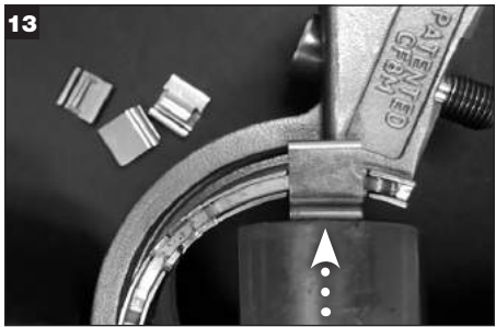
13 Irrota käytetyt jouset laipan puoliskoista naputtamalla niitä laipan puoliskon sisäpuolelta pienellä vasaralla.
