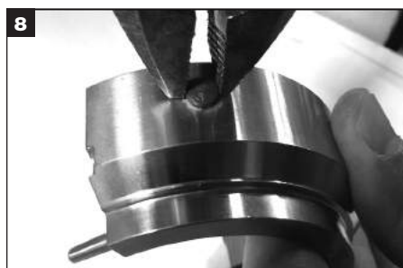
8 Irrota käytetyt keskityspalat pyörivän pidikkeen ulkopinnalta.
