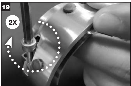
19 Voitele kierteet suositellulla kiinnileikkautumisen estoaineella ja asenna pidikkeen kantaruuvit pyörivän pidikkeen puoliskoon.
