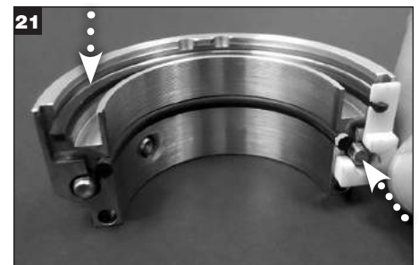
21 Asenna pyörivän pidikkeen kuljetusvälikkeet pyörivän pidikkeen puoliskoisiin pitämään pyörivän pinnan O-rennas paikallaan.
